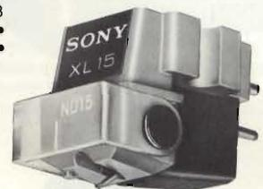
Tipo: MM • Tensione uscita a 1kHz: 4mV (5 cm/s) • Risposta di Frequenza: 10Hz - 30kHz • Separazione fra i canali a 1kHz: 26dB • Impedenza: 50/100 K $\Omega$  • Cedevolezza:  $15 \times 10^{-6}$  cm/dyne • Pressione d'esercizio puntina (valore medio): 1,2 g. (1,5) • Puntina: ND 25/Ellittica • Peso testina: 5,2 g.
