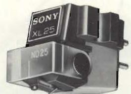
Tipo: MM • Tensione uscita a 1kHz: 3mV (5cm/s) • Risposta di Frequenza: 10Hz - 35kHz • Separazione fra i canali a 1kHz: 28dB • Impedenza: 50/100K $\Omega$  • Cedevolezza:  $15 \times 10^{-6}$  cm/dyne • Pressione d'esercizio (valore medio): 1,2 g. (1,5) • Puntina: ND 35/Ellittica • Peso testina: 5,5 g.
