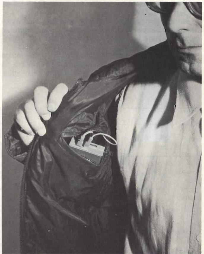
Fig. 1-A - Sistema per portare il ripetitore RP-2A in una tasca.
